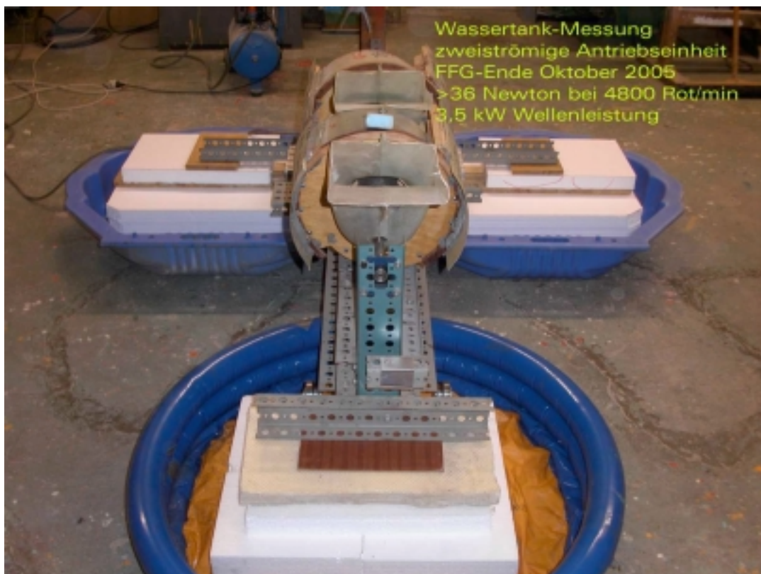
Abb. 15 Schubmessung mit Wassertanks
